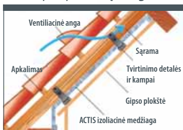
(2) Gipso plokščių dengimas:
